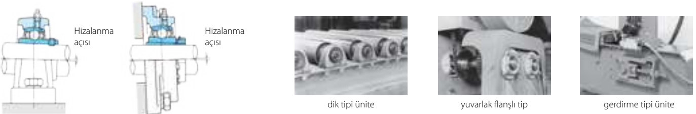
Şekil 1 Rulman yatağında izin verilen hizalama açısı
